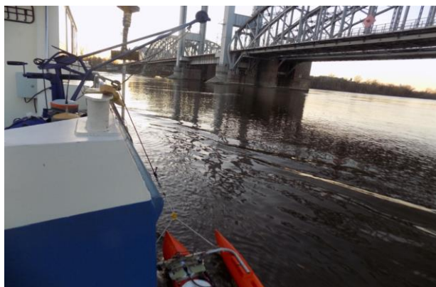
Фото 1 – Измерение скоростей и направлений течения воды в районе проектируемого мостового перехода (фотография с места работ).
