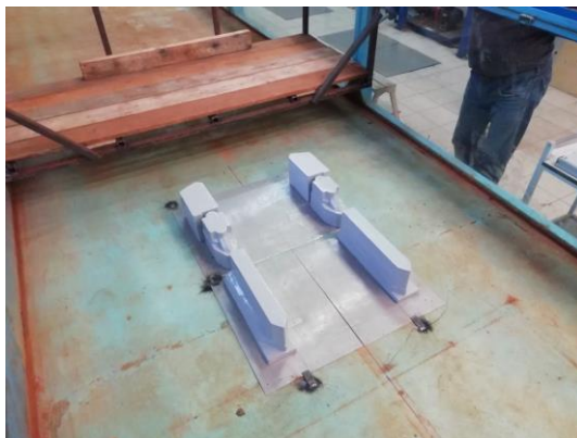
Фото 3 — Экспериментальное исследование по изучению характеристик речного потока в районе проектируемых опор мостового перехода (проектное состояние – с добавлением опор проектируемого моста).
