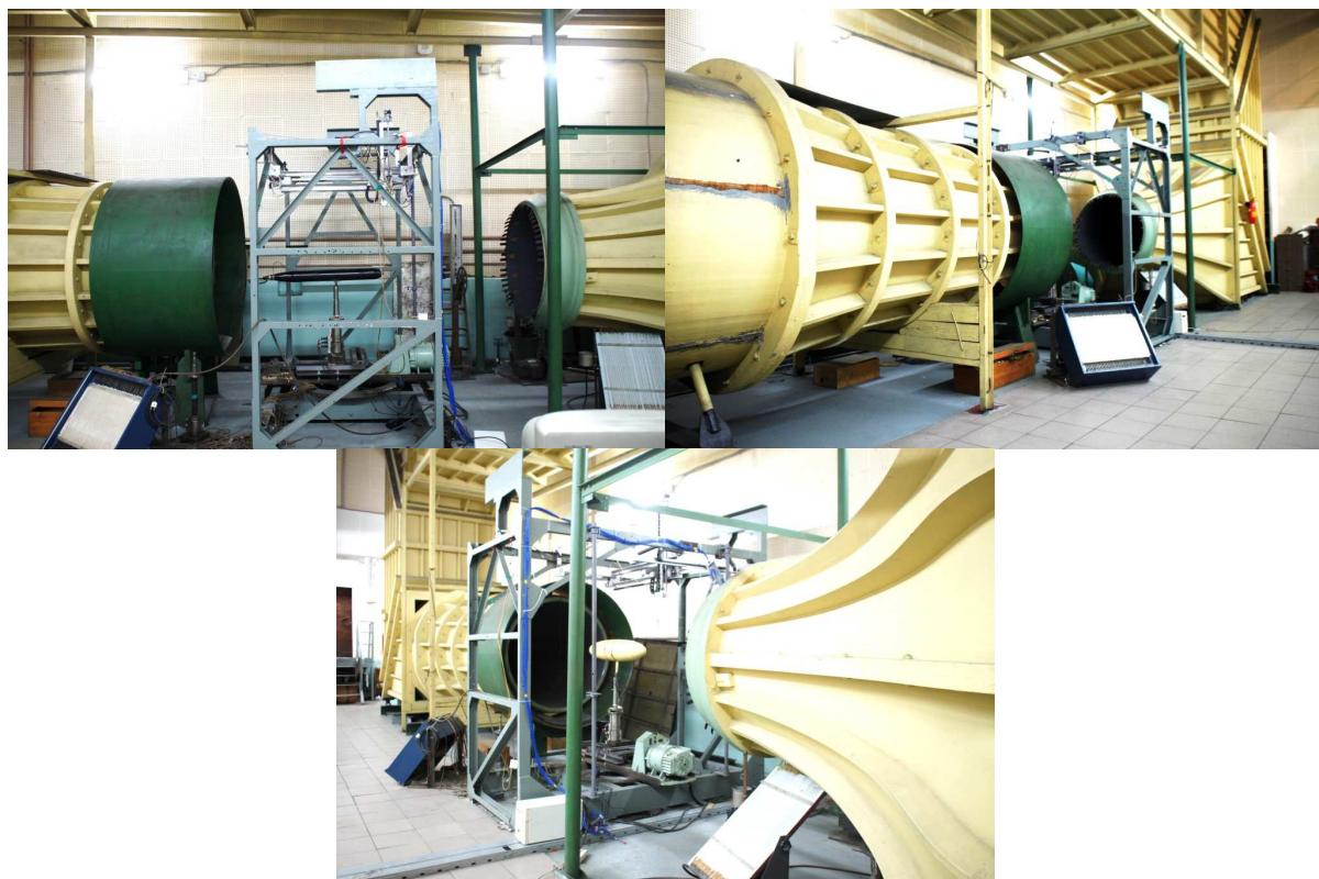
Установка гидродинамическая – аэродинамическая труба (регистрационный номер 588660) представляет собой трубу замкнутого типа с открытым рабочим участком. Задача установки заключается в измерении сил и моментов, действующих на объект, помещенный в воздушный поток.
